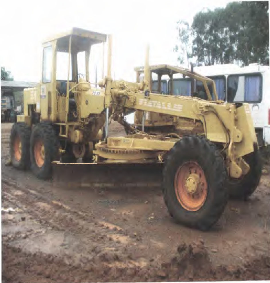
Motoniveladora Fiat Allis FG-85 Nº 10
